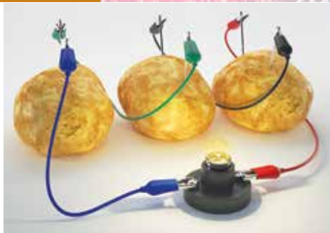
Gambar foto 1.5 Sel kimia daripada ubi kentang sebagai sumber tenaga elektrik
