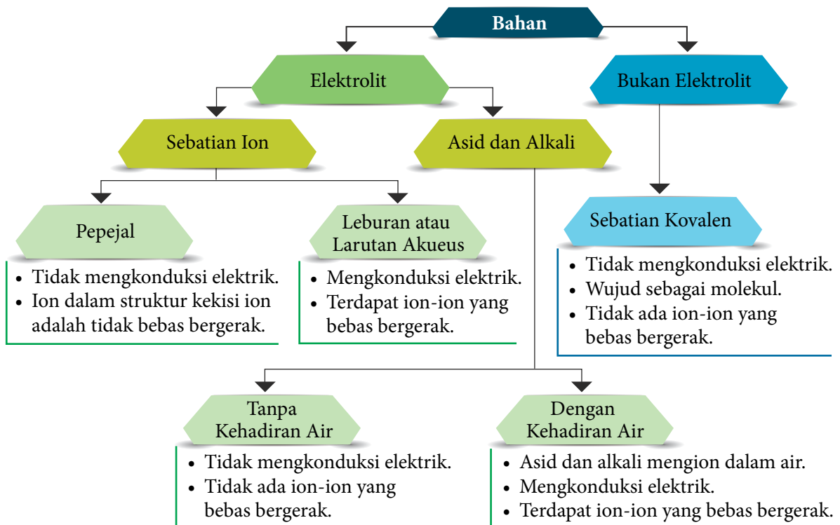
Rajah 1.20 Hubungan kekonduksian elektrik dengan kewujudan ion bebas bergerak
