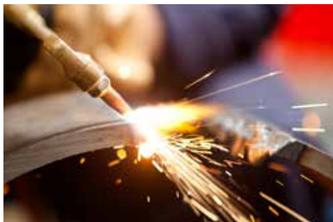
Gambar foto 2.5 Gas etuna digunakan dalam pemotongan logam
